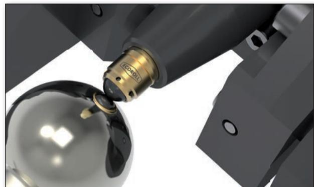
*Glattwalzen eines Kugelgelenkes*
