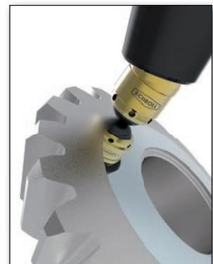
Glattwalzen der Kugelzone eines Kegelrades.
