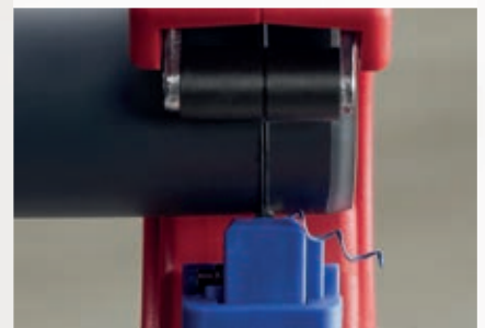
Sogar kurze Abschnitte ab nur ca. 10 mm sind möglich. Der gedrehte Span entsteht beim Anbringen der Fase.
