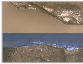
Ausbrüche nach 210 Sekunden Bearbeitung
