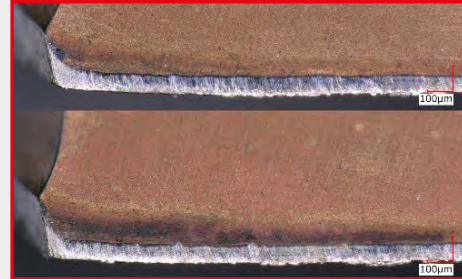
Freiflächenverschleiß nach 60 Bohrungen
