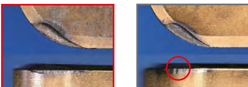
Absplittierungen nach 360 Sekunden Bearbeitung
