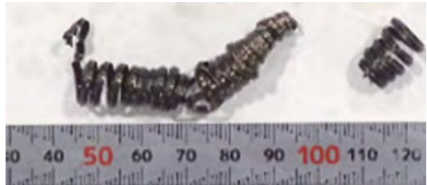
Butzenbildung im Zentrum: \varnothing 0.58 mm, Rz: 0.043 mm
