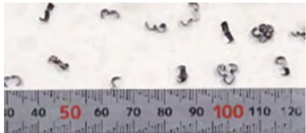
Butzenbildung im Zentrum: \varnothing 1.42 mm, Rz: 0.015 mm
