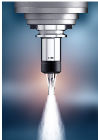
Abgedichtet für Werkzeuge mit interner Kühlschmierstoffzufuhr und zusätzliche Kühlmittelkanäle, um den Kühlschmierstoff auch für Werkzeuge ohne Kühlschmierstoffzufuhr an die Schneidkante zu führen.
